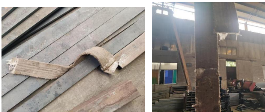
图 1 事发时使用的合成纤维吊装带
