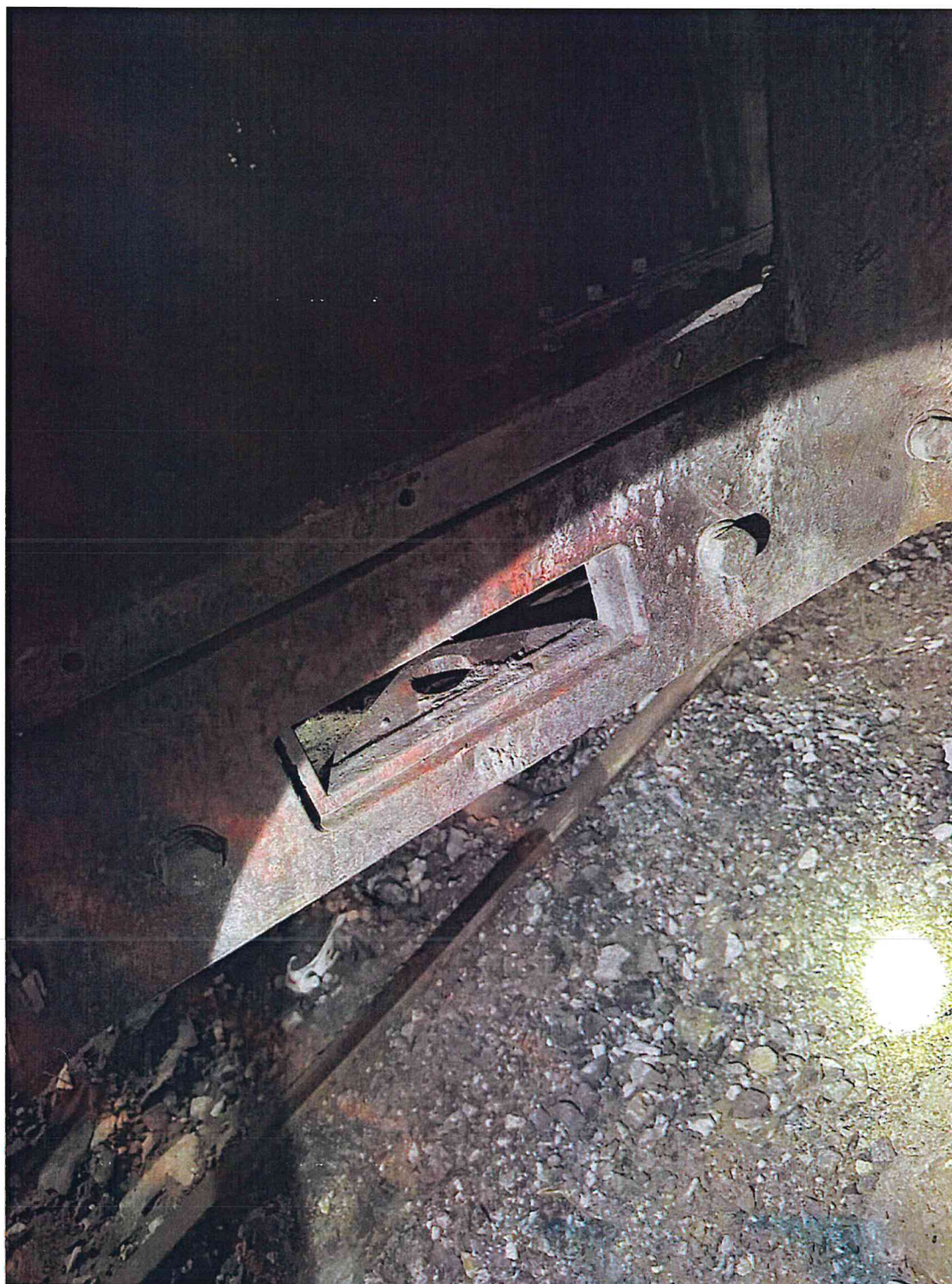
照片 10 铲运机尾部牵引栓洞
