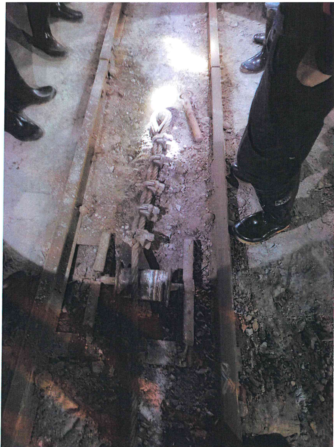
照片 2 主钢丝绳桃形接头
