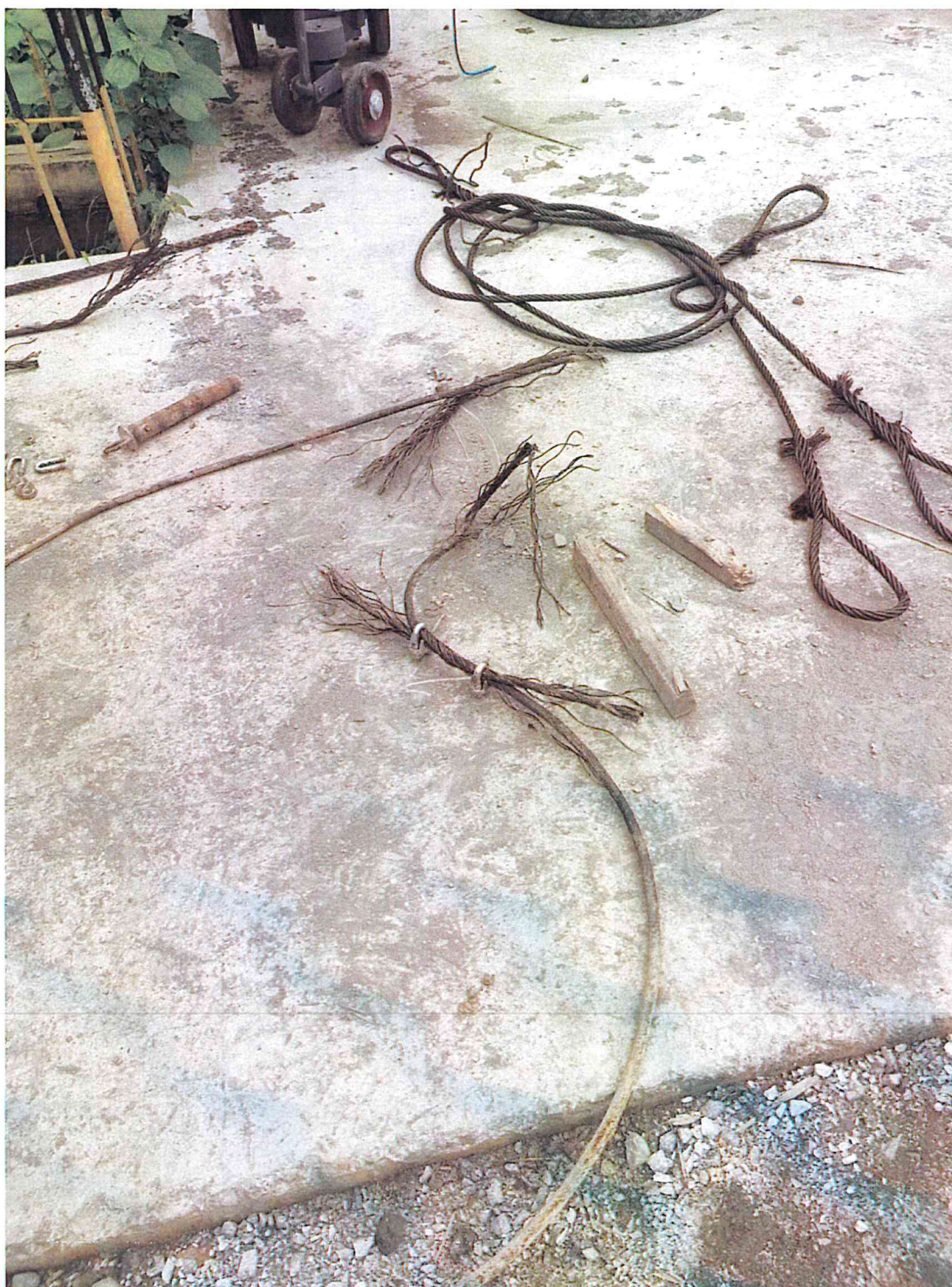
照片 1 断裂的钢丝绳（已拆卸至地表）
