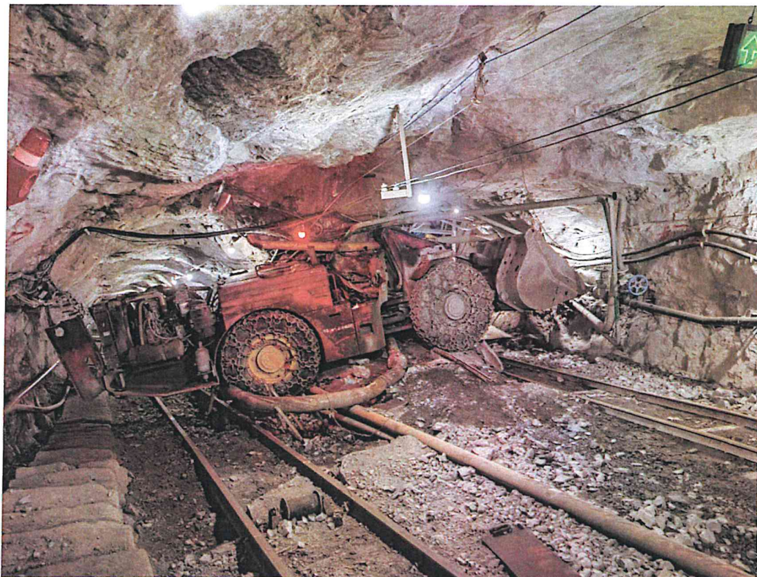
照片 4 事故铲运机（斜井与+330m 中段交叉处）
